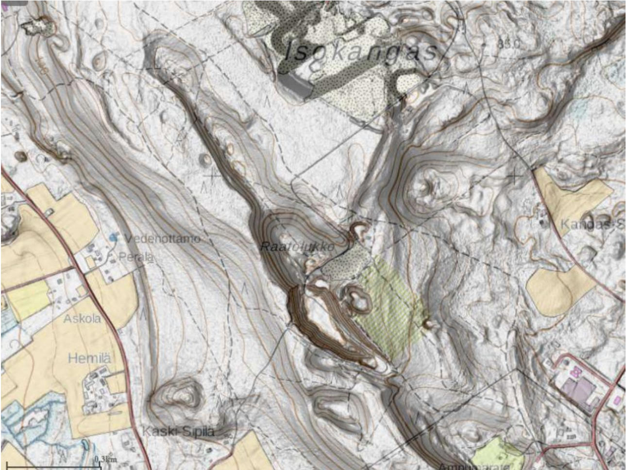
Kuva 15. Raatolukkaan päättyvä luode-kaakkoisuuntainen Isokankaan deltan pintaa halkova uomamainen painanne. Raatolukon suppa on kokonaisuuden syvin osa. Supan kaakkoislaita on käytännössä kokonaan soranoton jo poistama. Kaakkoislaidan tuorein ottoalue ja sinne Raatolukon koillispuolitse tuleva deltapintaan kaivettu tie eivät näy kuvassa. Lähde: https://gtkdata.gtk.fi/Maankamara/index.html . [8]
